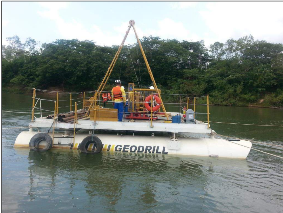
Foto 2 - Equipamentos de sondagem aquática posicionados no furo P 13.
