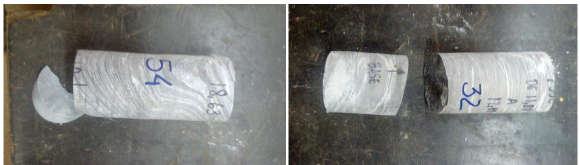
Foto 3 - Corpos de prova danificados
